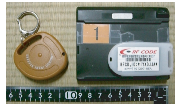
図 8 実験で使ったタグ。左が音による探し物支援システムのタグ、右が提案システムのタグ。
