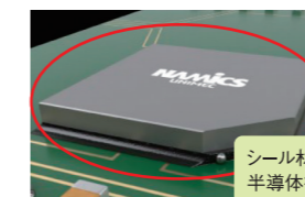
写真6 半導体用封止材 出所：ナミックス株式会社ホームページより一部改変
