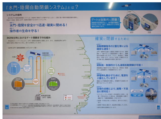
図2 岩手県水門・陸閘自動閉鎖システム
